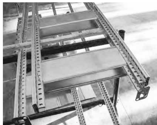
Verwendung eines Referenz-Rahmens als Montagevorlage
