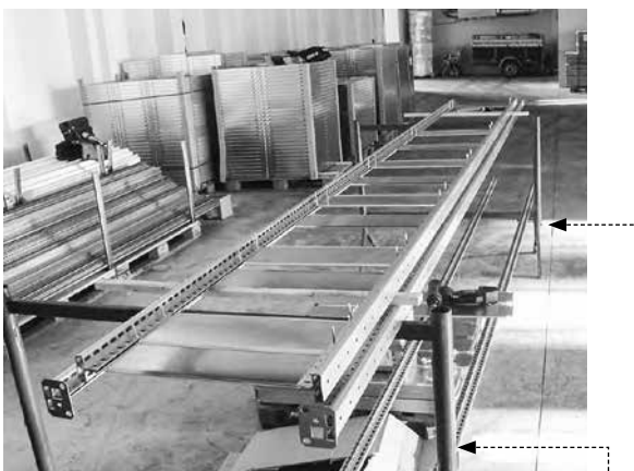
Geeignete Auflageböcke zur Montage verwenden!
